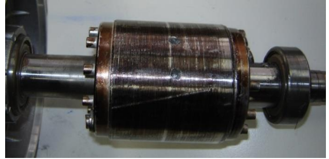
Fig. 3. : Défaut barre cassée.
