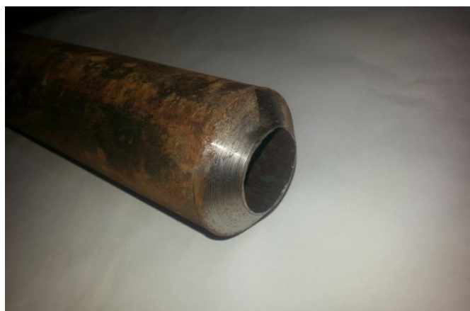
Fig. 12 Préparation des chanfreins selon les paramètres utilisés
