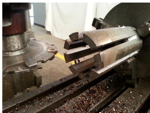
Fig. 16 Utilisation d'un plateau diviseur et une fraise disque pour le découpage
