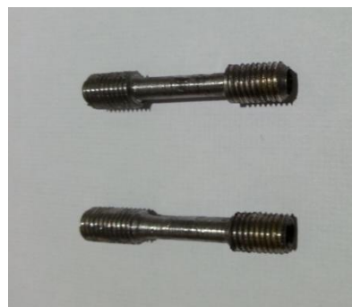
Fig. 21 Filetage et finition des éprouvettes
