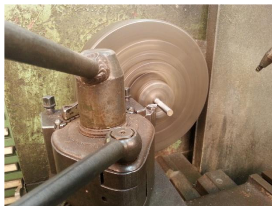
Fig. 20 Chariotage et dressage des éprouvettes par outil coudé
