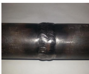
Fig. 15 Joint de soudure de l'acier T22
