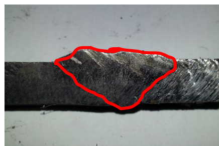
Fig. 18 Répartition des zones métallurgiques au niveau du cordon obtenu
