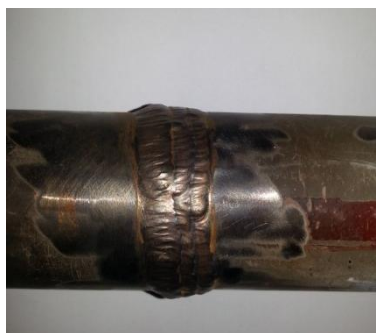
Fig. 14 Joint de soudure de l'acier T91
