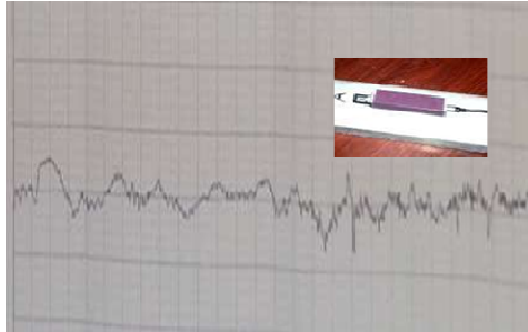
Figure 7 Rugosité de la face travaillante de l'outil en béton (Ra = 0.49 µm)
