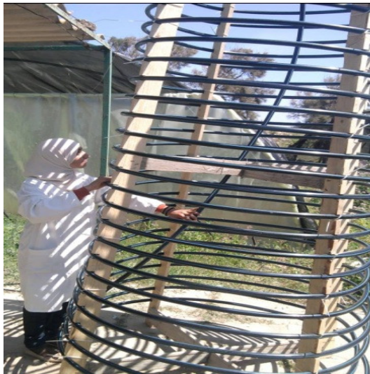
Fig. Réalisation de l'échangeur sous forme corbeille
